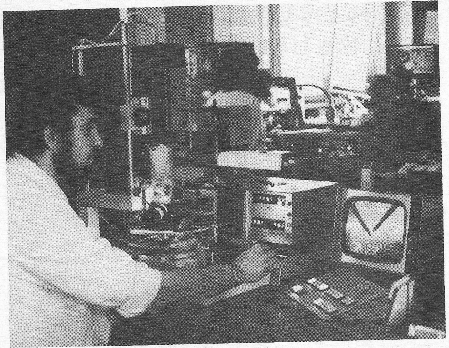
Afb. 17. Beproevingen van MOS-FET's in-wording d.m.v. een computer gestuurde chip-meet-automaat, ontwikkeld door AEG-Telefunken en in bedrijf in de halfgeleider fabriek in Heilbron.
